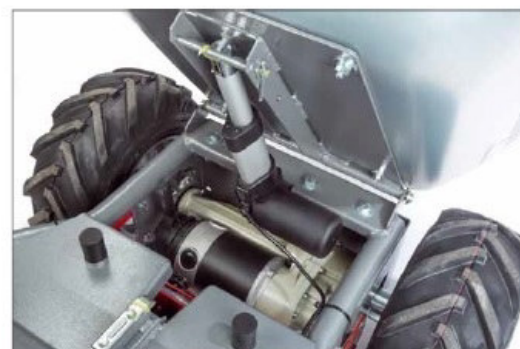
Sowohl der Linearmotor der Kippmechanik als auch der riesige Antriebsmotor mit Differential-getriebe hinterlassen einen sehr soliden Eindruck
