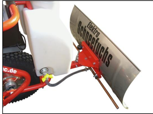
optional mit Flüssig-Taumittel-Behälter 13ltr. und Sprüh-Einrichtung
