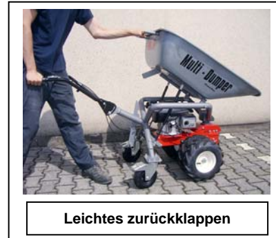
Entleeren mit Kipphilfe
