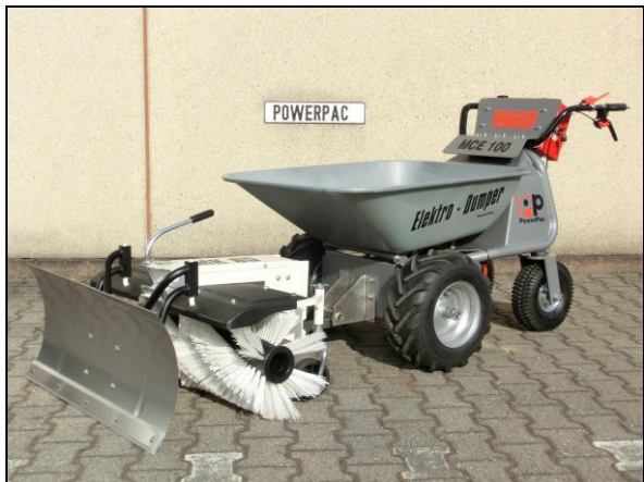
Kehrbesen 85cm - mech. schwenkbar inkl. Schneeschild 85cm und Adapter
