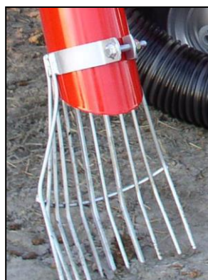
Saugrohr mit Forke für Anwendung auf z. B. Sand- oder Hackschnitzelböden
