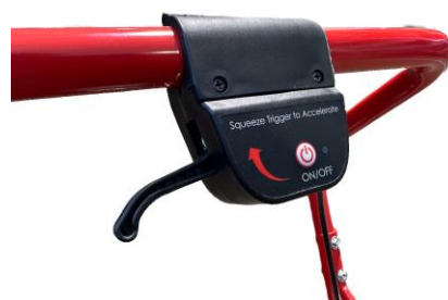
Fingerhebel mit stufenloser Geschwindigkeitsregulierung Ein/Aus Schalter
